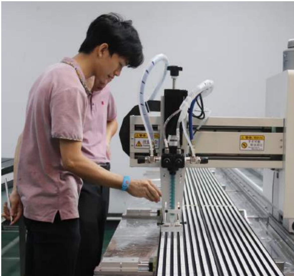
首先讲下PU胶，也称聚氨酯胶，一般为AB包装，产品的透光率在85-92%之间，固化后的灯条具有较好的柔韧性，固化后胶体可在-25℃到95℃之间长期使用；但因聚氨酯胶体硬度无法做到很低，产品仅能适用于滴胶型或者半套管型软灯条，其与PC表面粘接比较差，一般用手剥落后板上几乎无残留，此点也会影响到防水效果。但比较利于灯条返工时胶体的清理。随着温度的降低，灯条的柔韧性出现较大的变化；灌封时，对PC表面和环境湿度要求较高，若湿度过大，产品表面容易出现白雾和粘附力不够的现象；长期在户外使用，胶体通常2-3年出现黄变现象。
